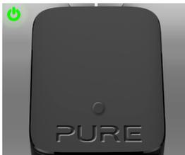
Sie haben die Rücksetzen-Taste an der Antenne gedrückt, nachdem die LED ausgegangen ist. Das Gerät befindet sich im Pairing-Modus. Um erneut zu pairen, drücken Sie gleichzeitig die Tasten
