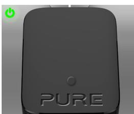
Compare quando si preme il pulsante di reset sull'antenna dopo lo spegnimento del LED. L'unità si trova in modalità di accoppiamento. Per ritentare l'accoppiamento, tenere premuto
