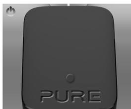
Indique que l'antenne est alimentée. Visible lors de la première mise sous tension de l'antenne. Après l'extinction de la DEL, votre boîtier de commande devrait se connecter automatiquement.
