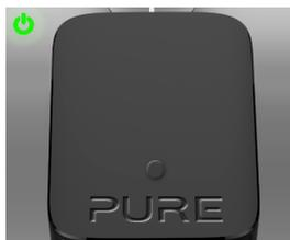
Compare quando si preme il pulsante di reset sull'antenna dopo lo spegnimento del LED. L'unità si trova in modalità di accoppiamento. Per ritentare l'accoppiamento, tenere premuto
